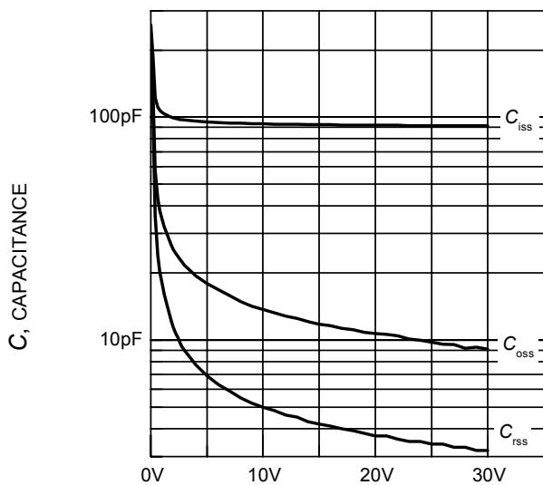
$V_{CE}$ , COLLECTOR-EMITTER VOLTAGE
