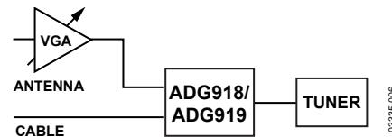
Figure 27. Tuner Modules
