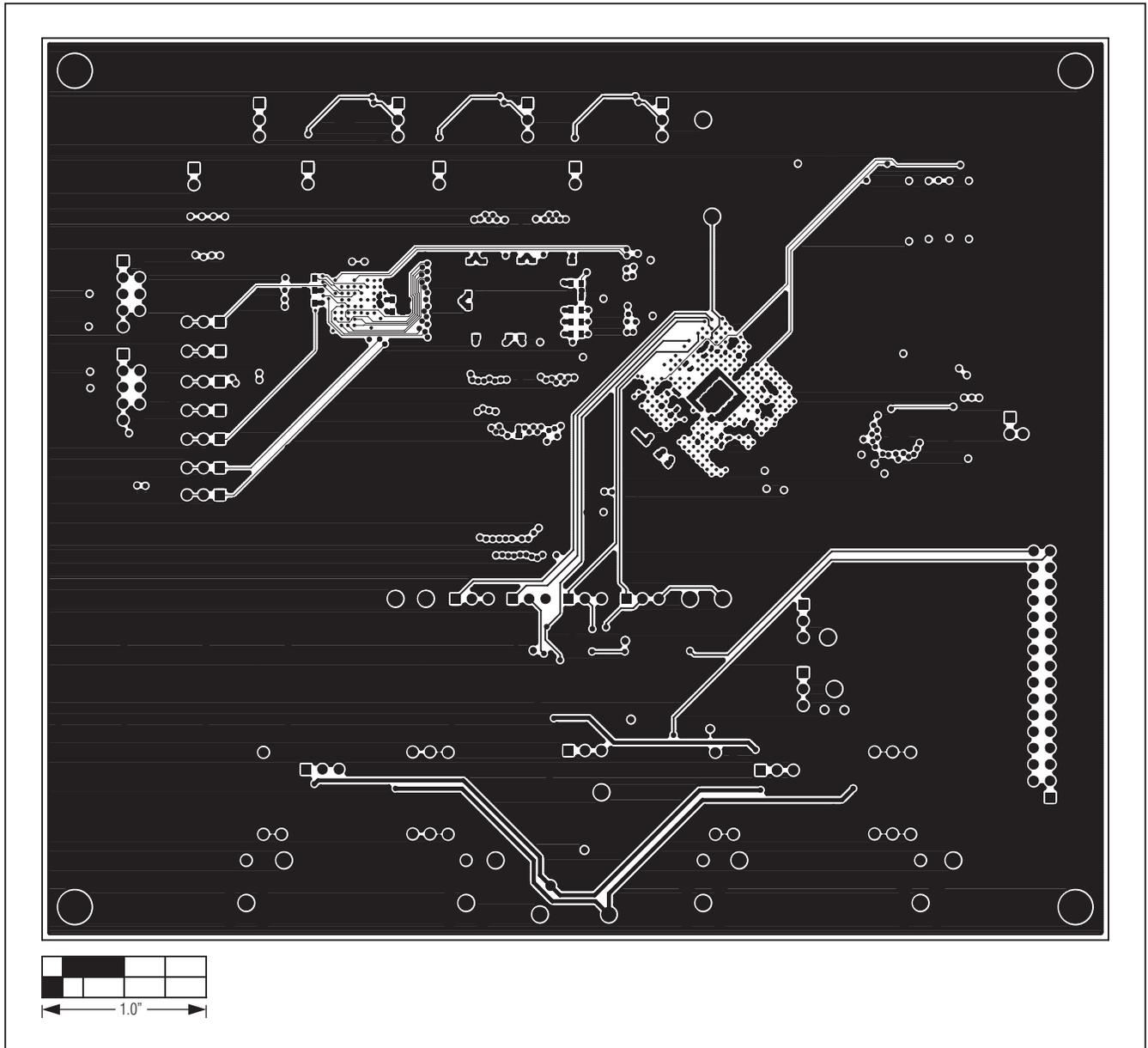
Figure 19. MAX11666 EV Kit PCB Layout— Bottom Side
