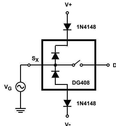
FIGURE 9. OVERRVOLTAGE PROTECTION USING BLOCKING DIODES
