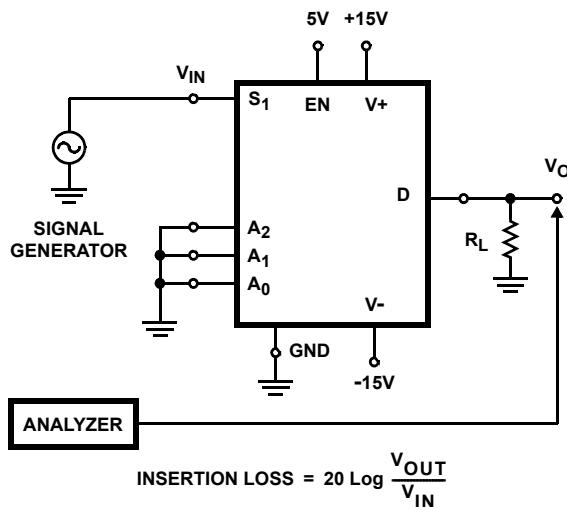
FIGURE 7. INSERTION LOSS
