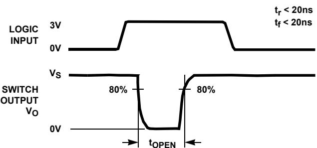
FIGURE 3. BREAK-BEFORE-MAKE INTERVAL
