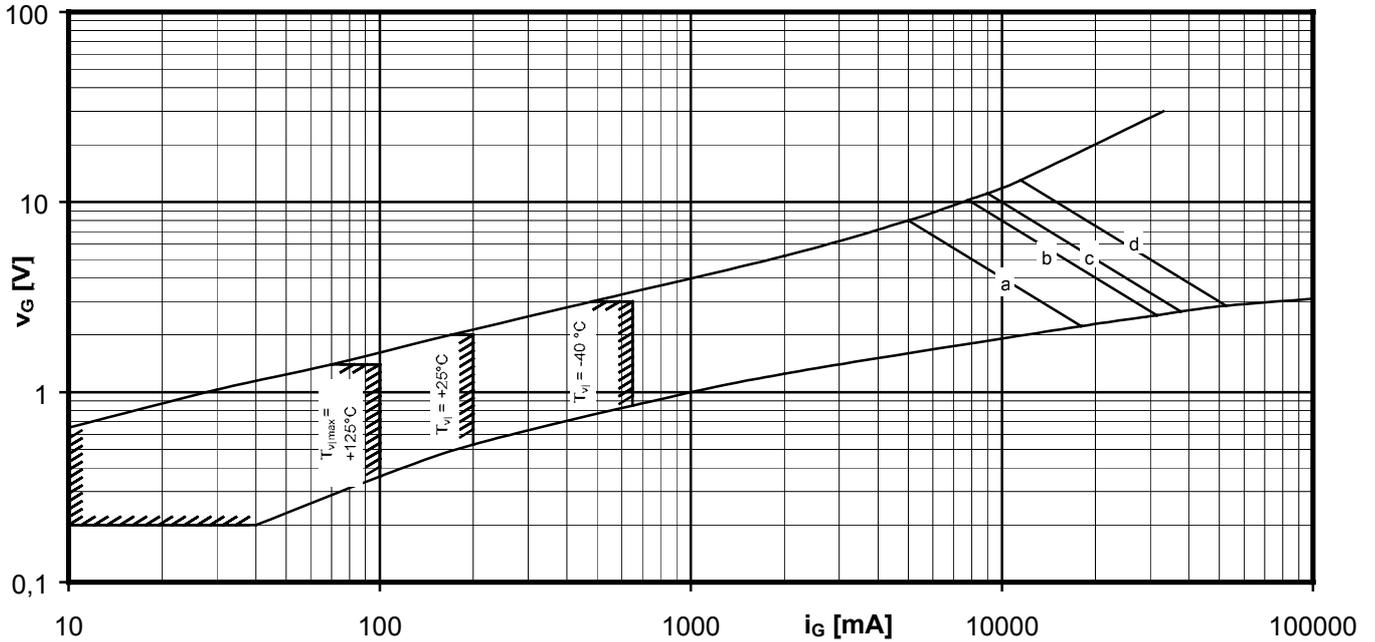
Steuercharakteristik  $v_G = f(i_G)$  mit Zündbereichen für  $V_D = 6\text{ V}$
