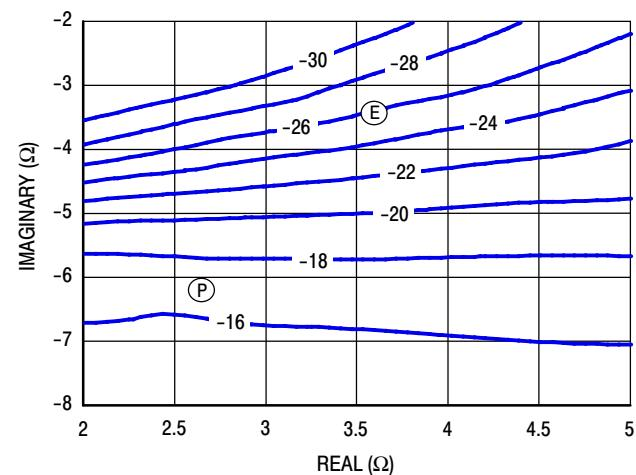
Figure 17. P3dB Load Pull AM/PM Contours (°)
