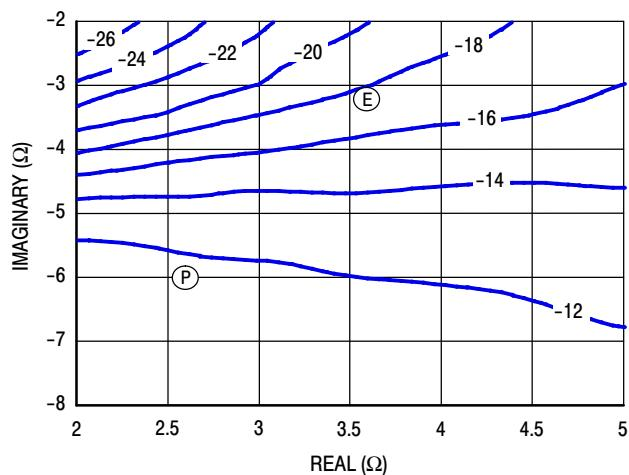
Figure 13. P1dB Load Pull AM/PM Contours (°)
