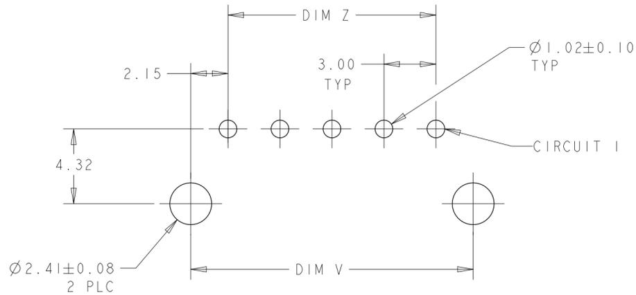
PCB LAYOUT COMPONENT SIDE 4
