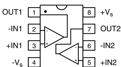
**CLC2007 Pin Assignments****SOIC-8 / MSOP-8**
