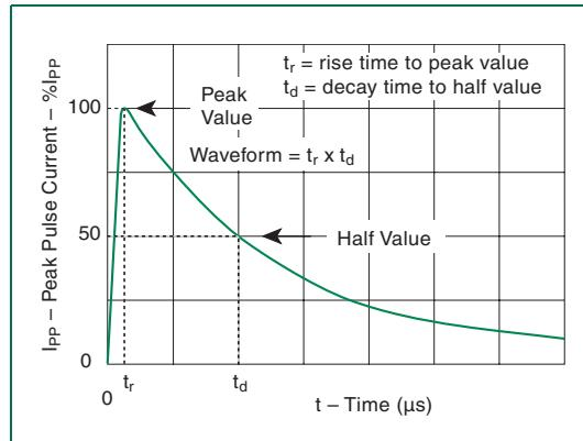
t<sub>r</sub> x t<sub>d</sub> Pulse Waveform
