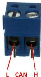
Figure 43: CAN1 Terminal Block
