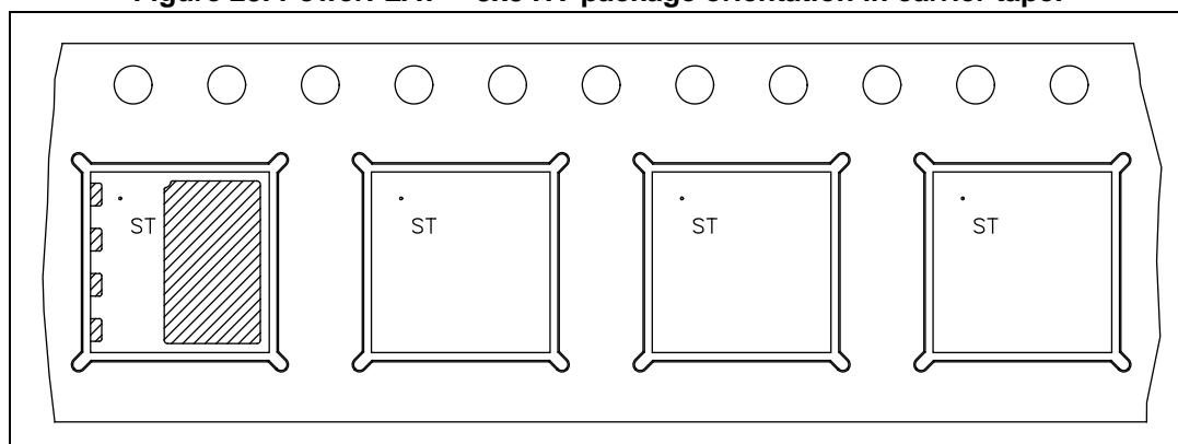
Figure 24. PowerFLAT™ 8x8 HV reel
