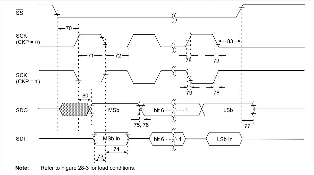
**TABLE 28-16: EXAMPLE SPI MODE REQUIREMENTS (SLAVE MODE TIMING, CKE = 0)**
