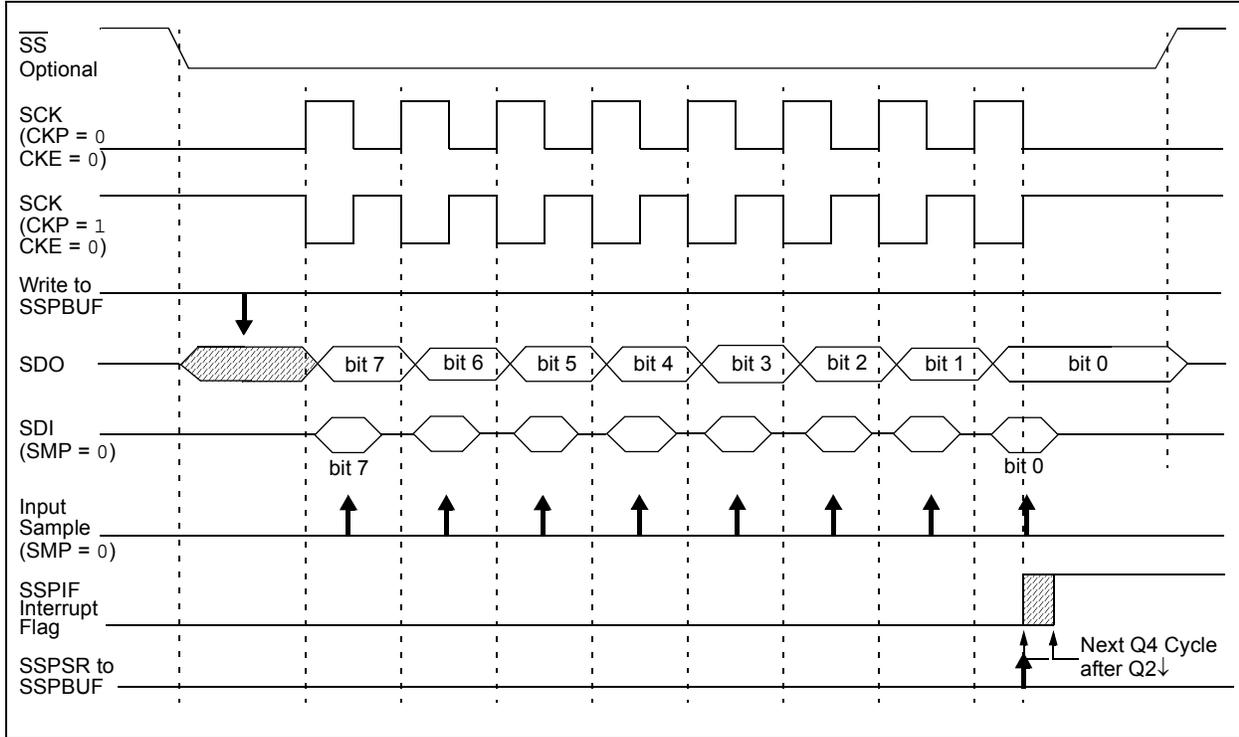
**FIGURE 18-6: SPI MODE WAVEFORM (SLAVE MODE WITH CKE = 1)**
