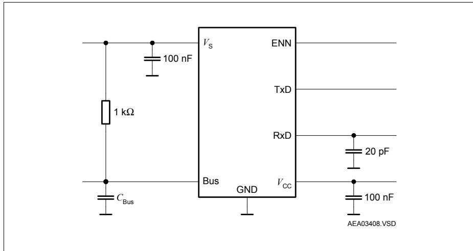
**Figure 4** Test Circuits
