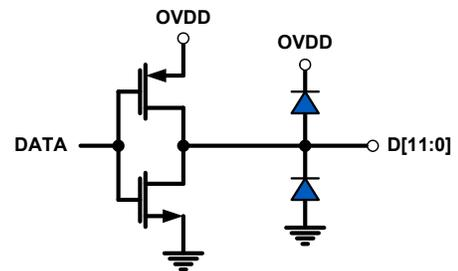
FIGURE 48. CMOS OUTPUTS
