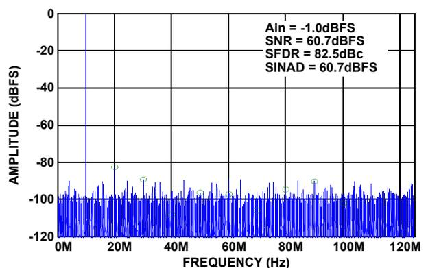
FIGURE 16. SINGLE-TONE SPECTRUM AT 10MHz
