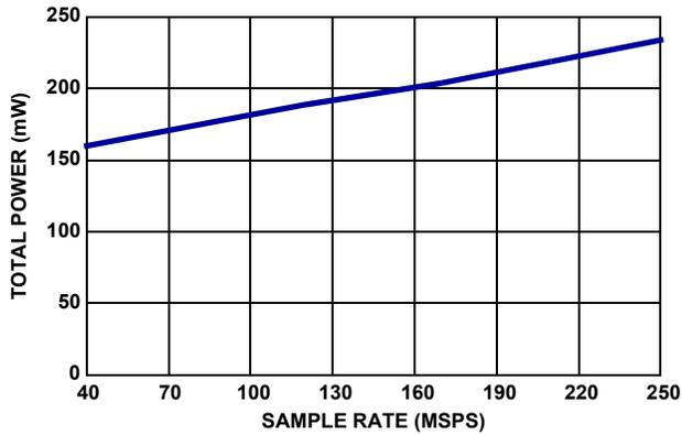
FIGURE 11. POWER vs f<sub>SAMPLE</sub> IN 3mA LVDS MODE
