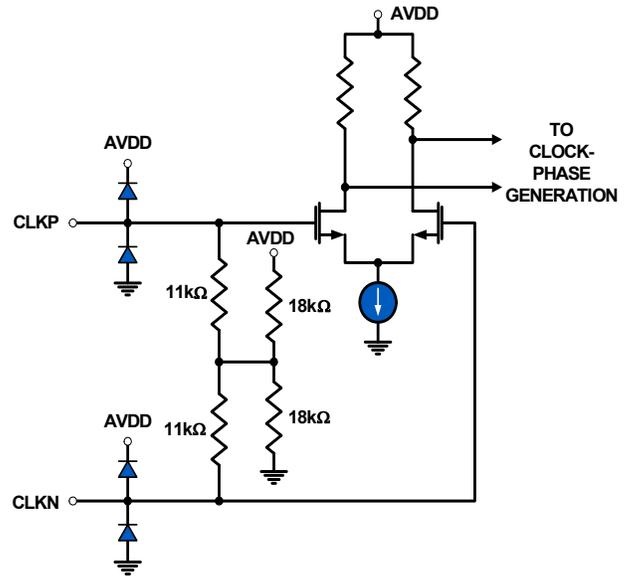
FIGURE 44. CLOCK INPUTS
