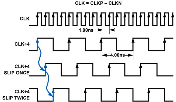
**FIGURE 41. PHASE SLIP: CLK÷4 MODE, f<sub>CLock</sub> = 1000MHz**
