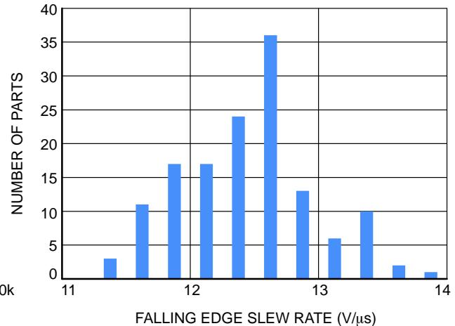
Figure 23. Falling Edge Slew Rate @ VS = 5 V
