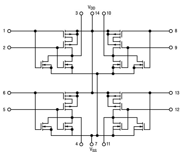
**MC14011UB CIRCUIT SCHEMATIC
