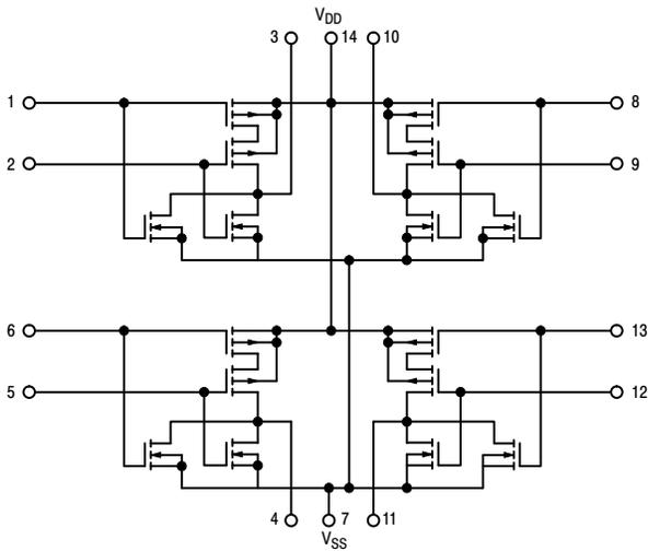
**MC14011UB CIRCUIT SCHEMATIC
