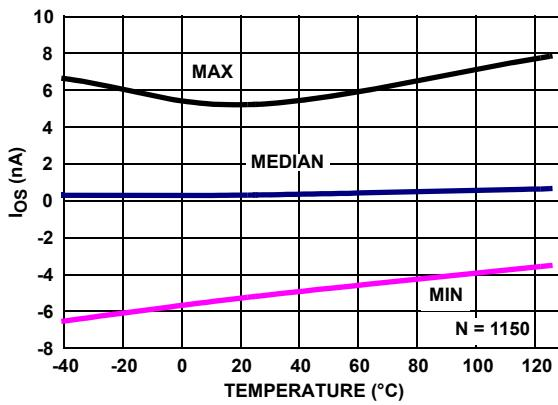
FIGURE 30.  $I_{OS}$  vs TEMPERATURE,  $V_+, V_- = \pm 2.5V$
