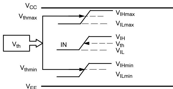
**Figure 4.  $V_{th}$  Diagram**
