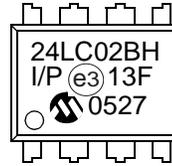
8-Lead SOIC (3.90 mm)
