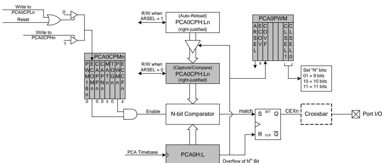
**Figure 25.9. PCA 9, 10 and 11-Bit PWM Mode Diagram**
