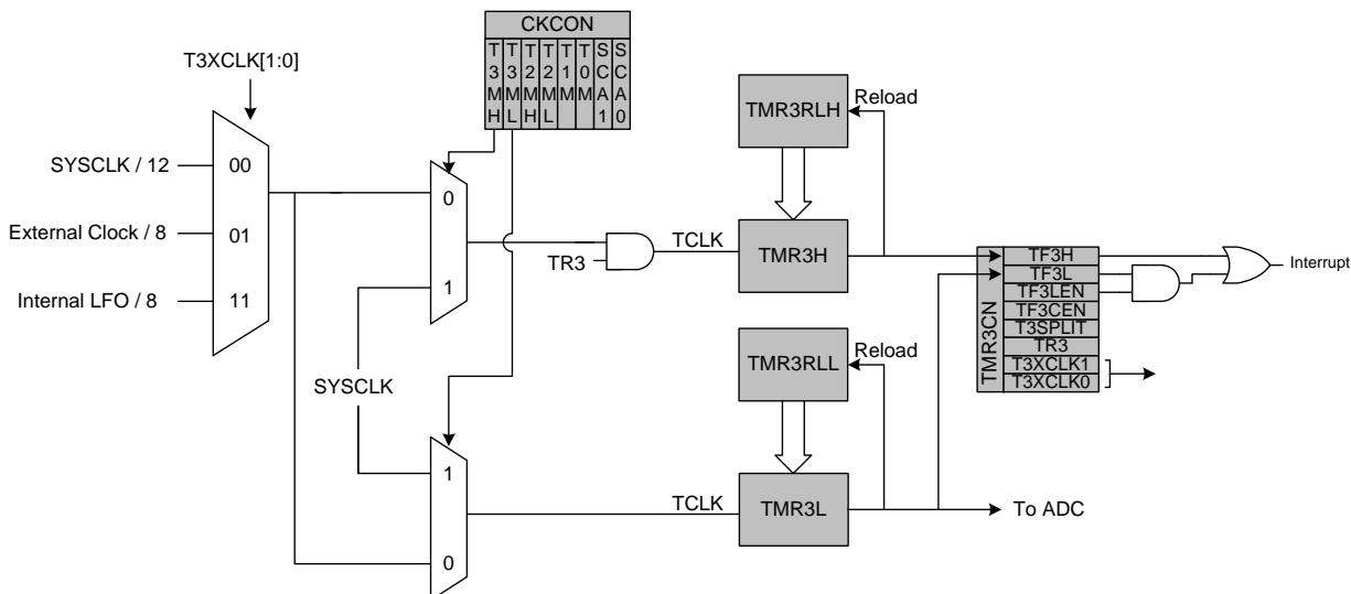
Figure 24.8. Timer 3 8-Bit Mode Block Diagram
