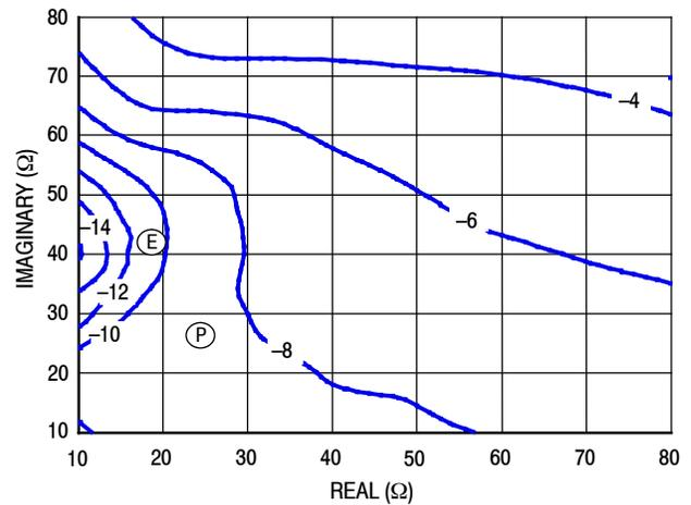
Figure 12. P1dB Load Pull AM/PM Contours (°)
