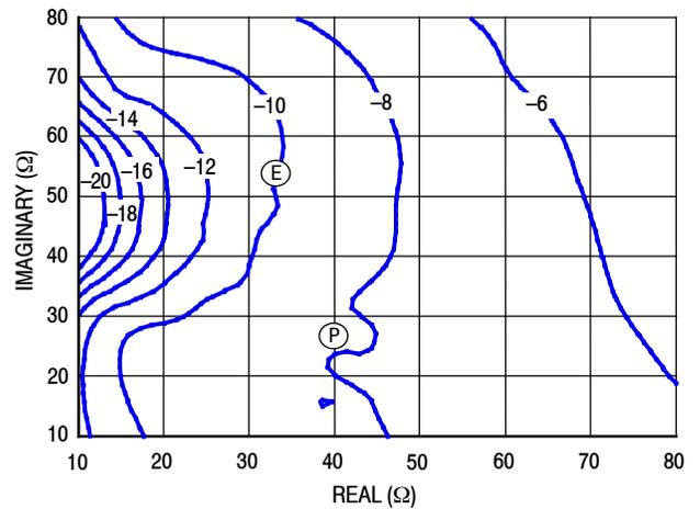
Figure 24. P1dB Load Pull AM/PM Contours (°)
