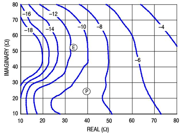
Figure 28. P3dB Load Pull AM/PM Contours (°)
