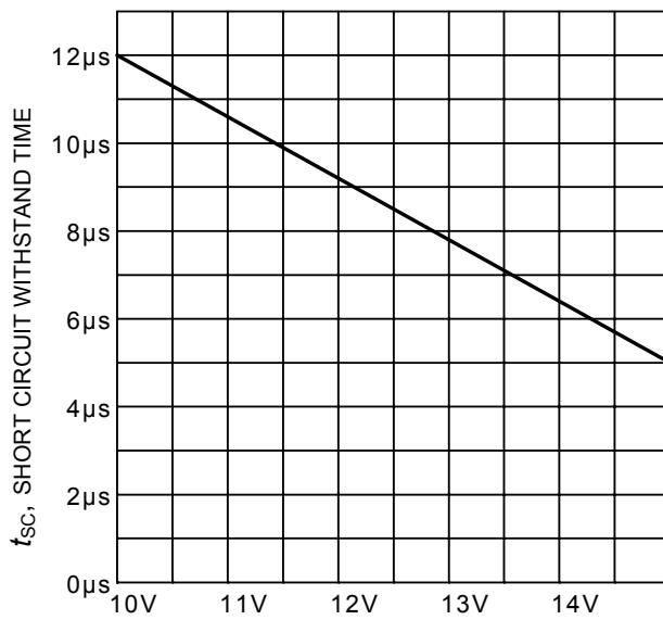
$V_{GE}$ , GATE-EMITTER VOLTAGE
