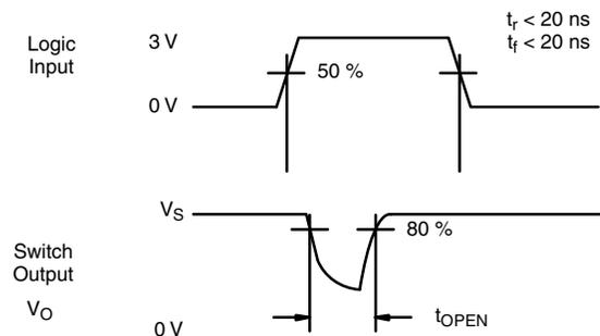
Fig. 4 - Break-Before-Make Interval
