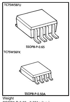
SSOP8-P-0.65 : 0.021g (typ.) SSOP8-P-0.50A : 0.01g (typ.)
