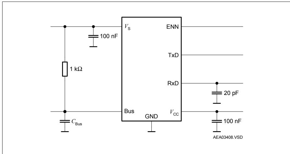
**Figure 4** Test Circuits
