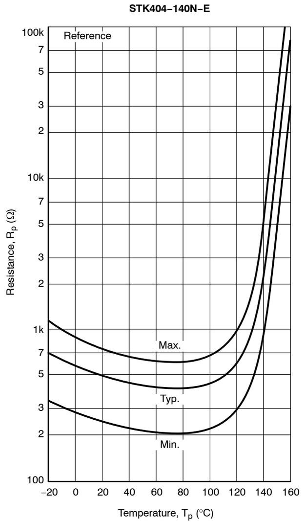
**Figure 27.  $R_p$  vs.  $T_p$**
