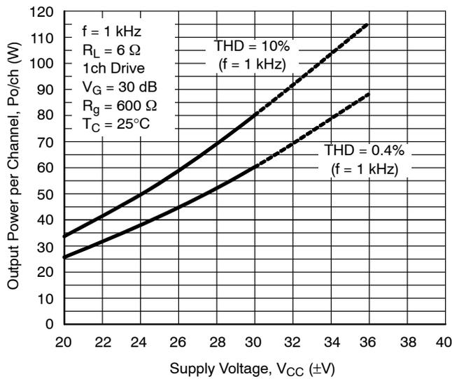
Figure 14. Po vs. V<sub>CC</sub>
