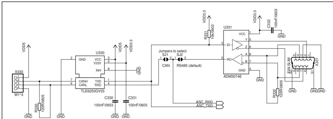
**Figure 5 RS485/CAN BootLoader**
