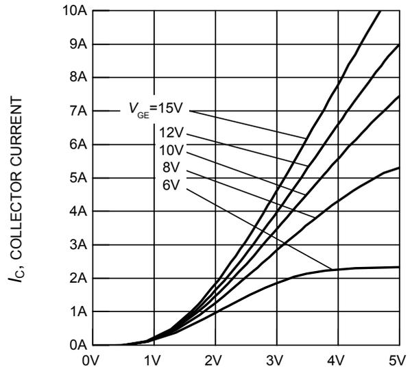
$V_{CE}$ , COLLECTOR-EMITTER VOLTAGE
