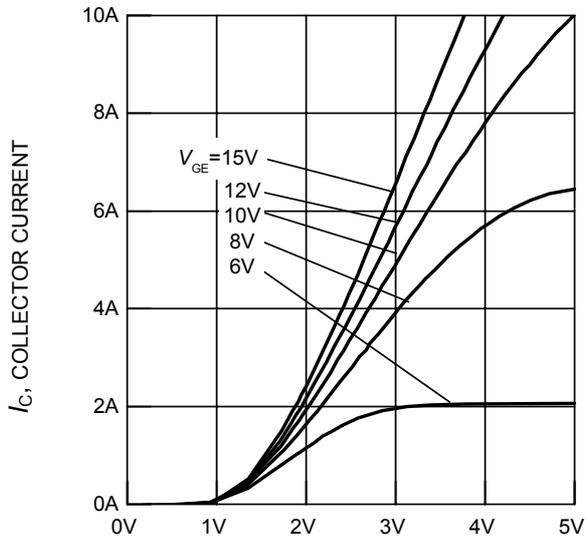
$V_{CE}$ , COLLECTOR-EMITTER VOLTAGE
