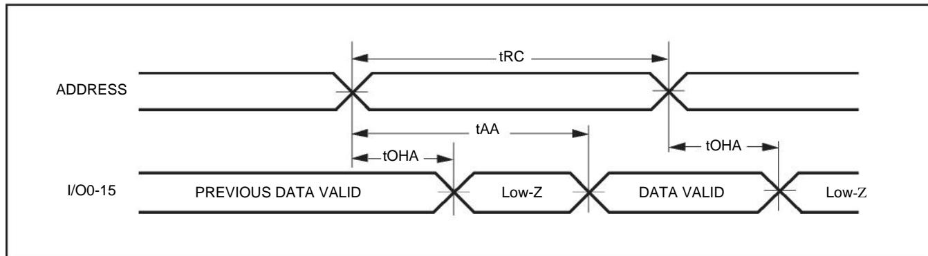
**READ CYCLE NO. 2<sup>(1,3)</sup> ( $\overline{CS1}$ ,  $CS2$ ,  $\overline{OE}$ , AND  $\overline{UB}$  &  $\overline{LB}$  CONTROLLED)**
