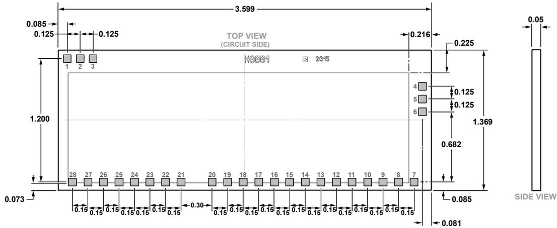
Figure 41. 28-Pad Bare Die [CHIP]
