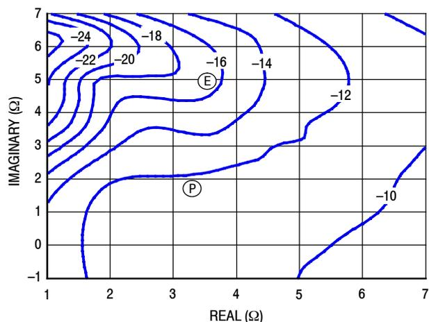
Figure 23. P1dB Load Pull AM/PM Contours (°)
