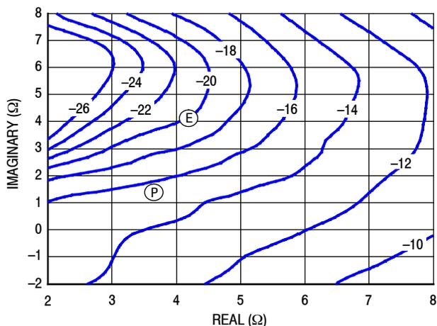
**Figure 27. P3dB Load Pull AM/PM Contours (°)**
