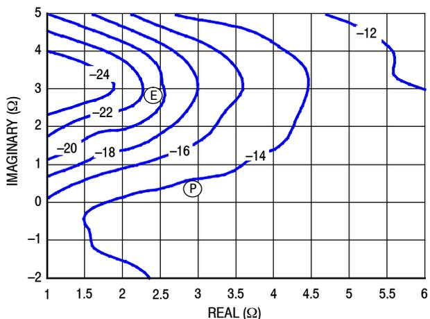
Figure 11. P1dB Load Pull AM/PM Contours (°)
