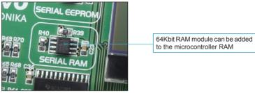
Figure 13-1: Serial RAM module
