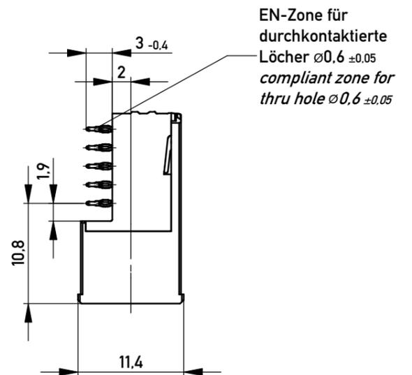
EN-Zone für durchkontaktierte Löcher  $\varnothing 0,6 \pm 0,05$
