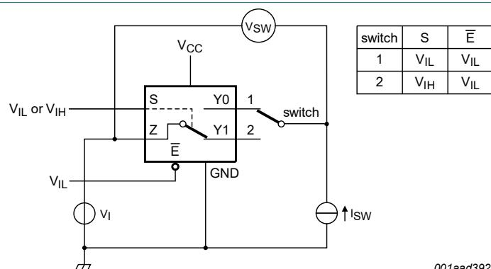
$$R_{ON} = V_{sw} / I_{sw}$$
