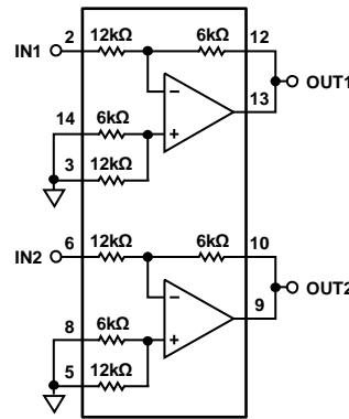
$$V_{\text{OUT}} = -\frac{1}{2} V_{\text{IN}}$$
