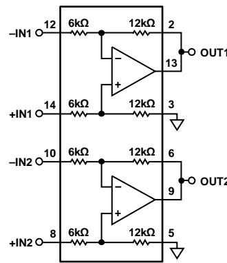
$$V_{\text{OUT}} = 2 (V_{\text{IN}+} - V_{\text{IN}-})$$
