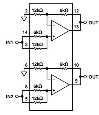
$V_{\text{OUT}} = 1\frac{1}{2} V_{\text{IN}}$
