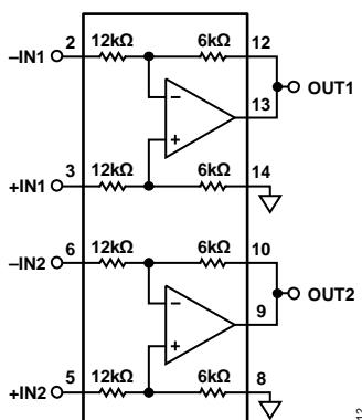
$$V_{\text{OUT}} = \frac{1}{2} (V_{\text{IN}+} - V_{\text{IN}-})$$
