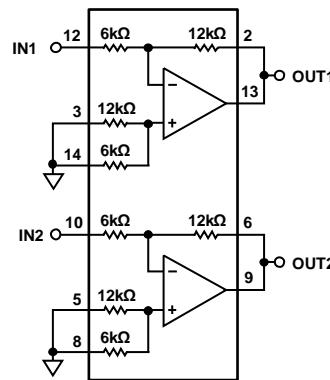
$$V_{\text{OUT}} = -2 V_{\text{IN}}$$
