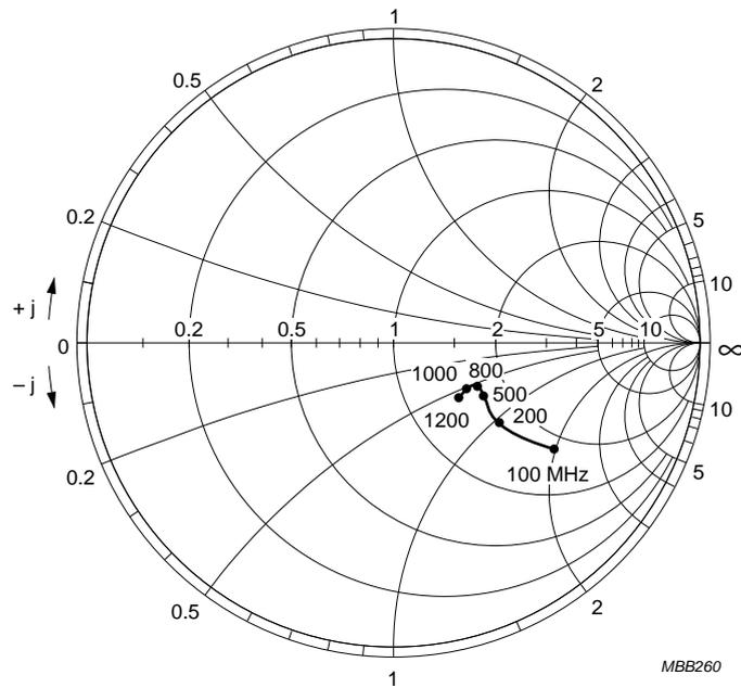
$I_C = 30 \text{ mA}$ ;  $V_{CE} = 8 \text{ V}$ ;  $Z_o = 50 \text{ } \Omega$ ;  $T_{amb} = 25 \text{ }^\circ\text{C}$ .
