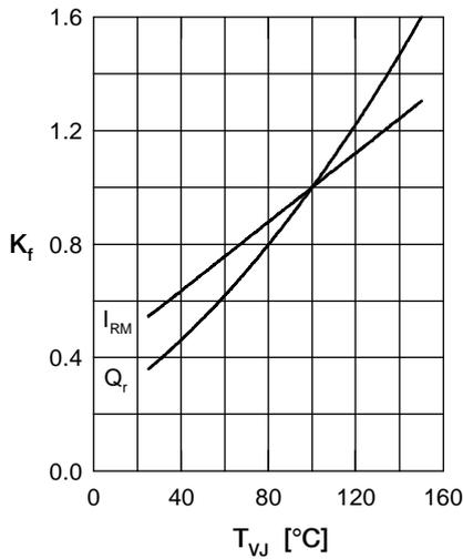
Fig. 4 Typ. dynamic parameters  $Q_r$ ,  $I_{RM}$  versus  $T_{VJ}$
