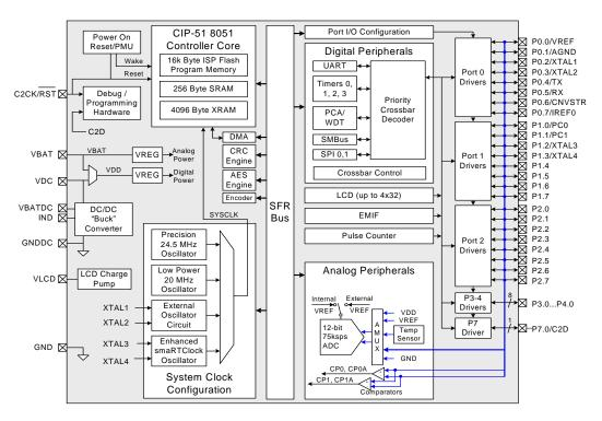
Figure 1.10. C8051F969 Block Diagram
