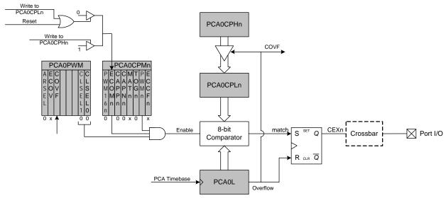
Figure 33.8. PCA 8-Bit PWM Mode Diagram
