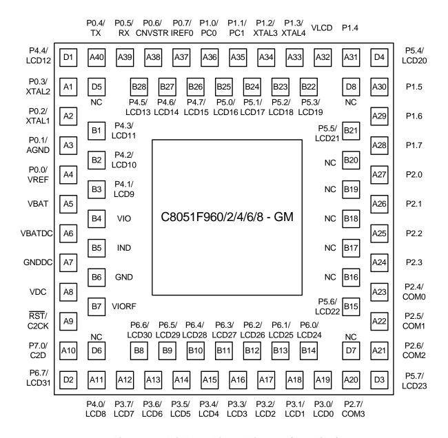
Figure 3.1. DQFN-76 Pinout Diagram (Top View)
