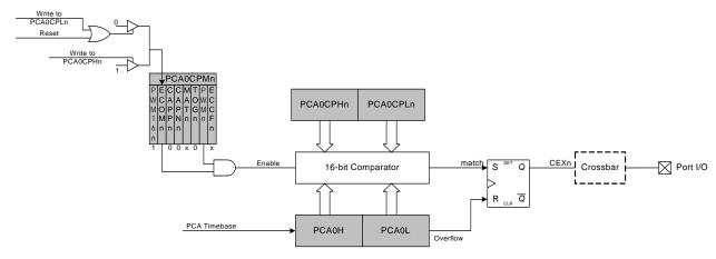
Figure 33.10. PCA 16-Bit PWM Mode
