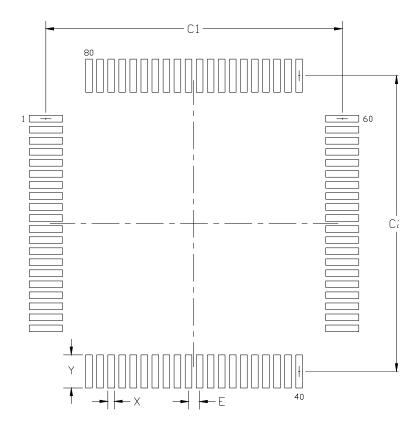
Figure 3.10. TQFP80 Landing Diagram
