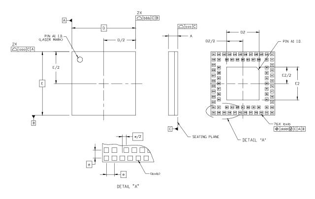
Figure 3.4. DQFN-76 Package Drawing
