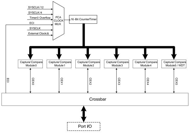
Figure 1.12. PCA Block Diagram
