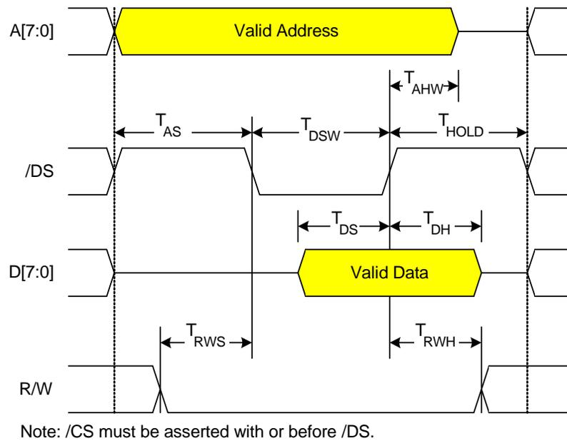
**Figure 27. Nonmuxed Motorola WRITE**
