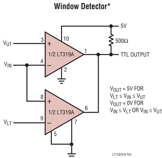
\*ALLOWED WINDOW FOR SINGLE 5V SUPPLY IS 1.2V TO 3.8V
