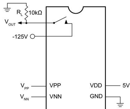
T<sub>ON</sub>/T<sub>OFF</sub> Test Circuit
