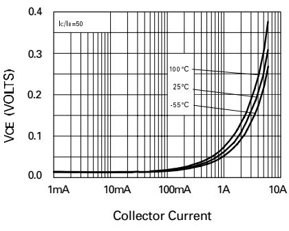
$\mathbf{V_{CE(sat)} \text{ vs } I_C}$
