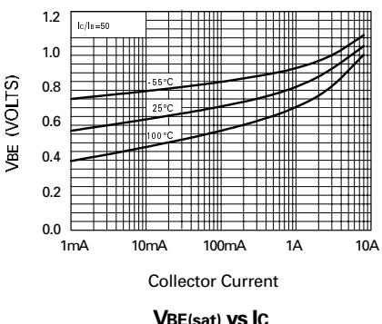
$\mathbf{V_{BE(sat)} \text{ vs } I_C}$
