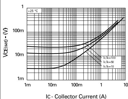
$\mathbf{V_{CE(sat)} \text{ vs } I_C}$
