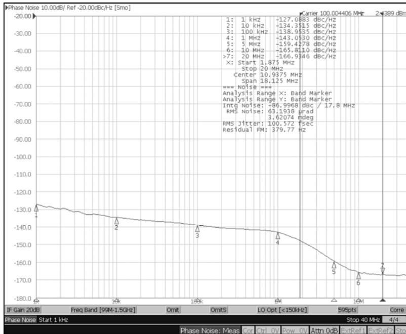
Phase Noise Plot: 100MHz, 1.875MHz – 20MHz 101fS
