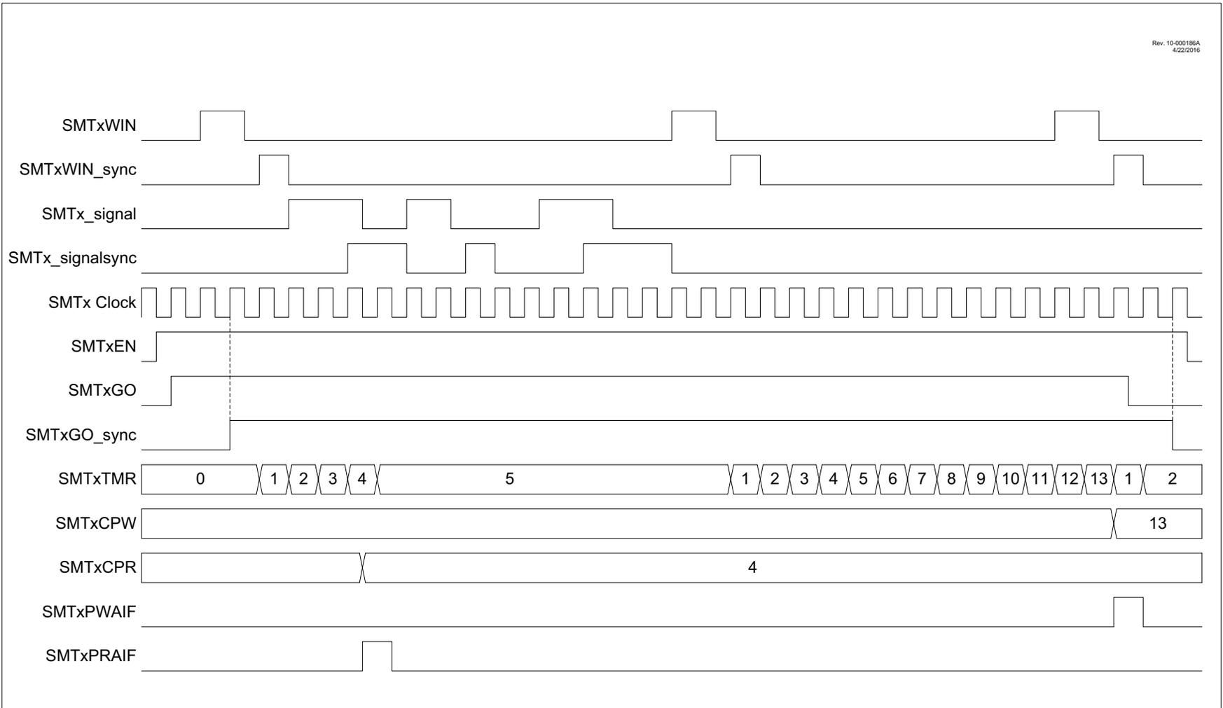
**FIGURE 25-15: TIME OF FLIGHT MODE SINGLE ACQUISITION TIMING DIAGRAM**
