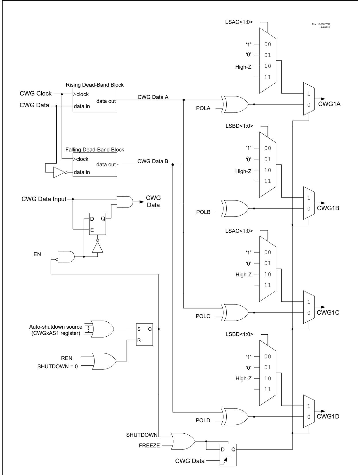
**FIGURE 26-2: CWGx HALF-BRIDGE MODE OPERATION**
