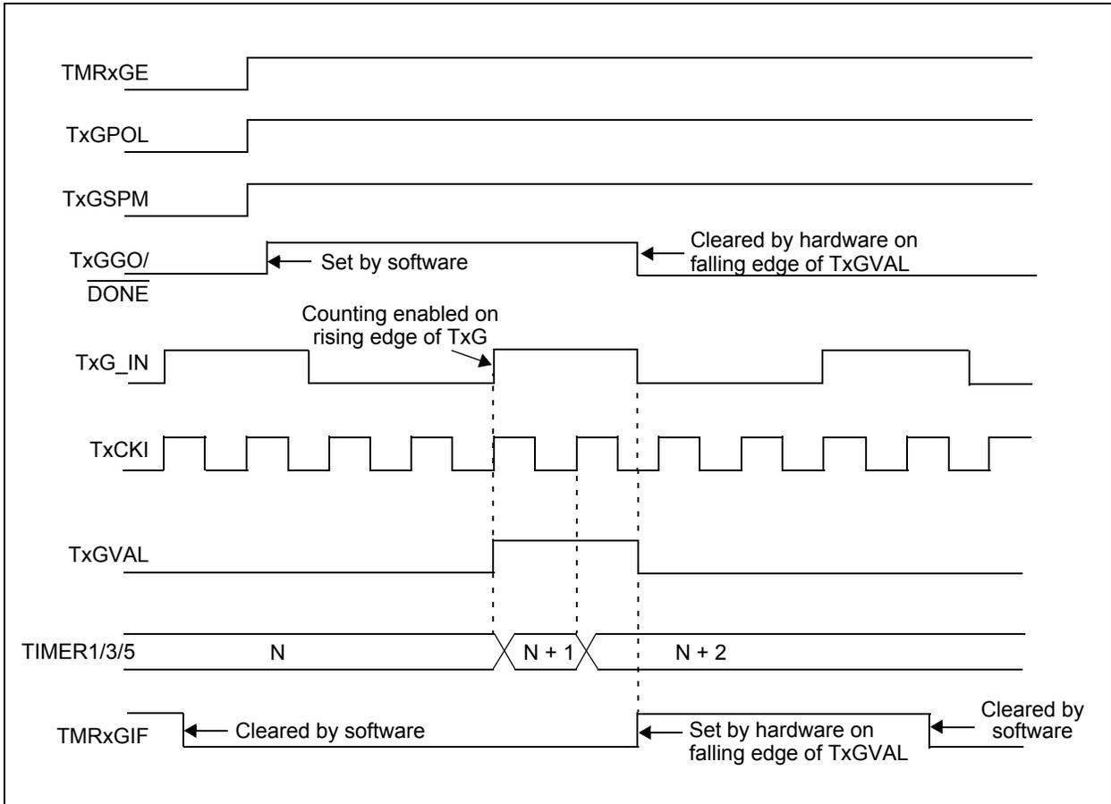
**FIGURE 21-7: TIMER1/3/5 GATE SINGLE-PULSE AND TOGGLE COMBINED MODE**
