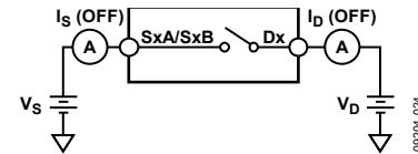
Figure 28. Off Leakage
