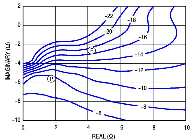
Figure 31. P1dB Load Pull AM/PM Contours (°)
