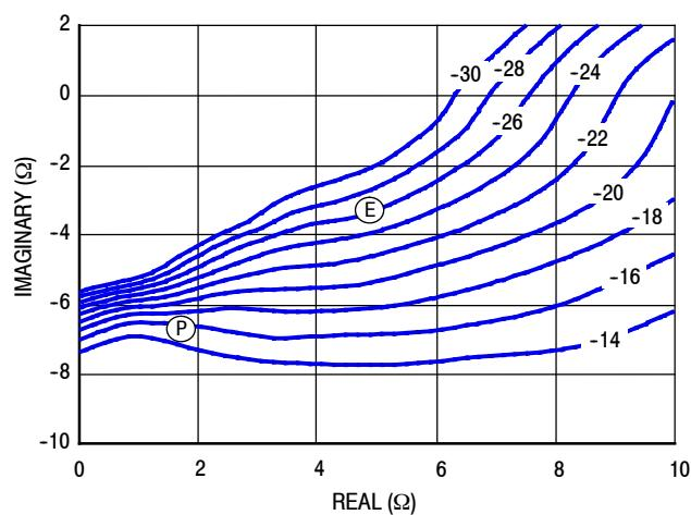
Figure 43. P3dB Load Pull AM/PM Contours (°)
