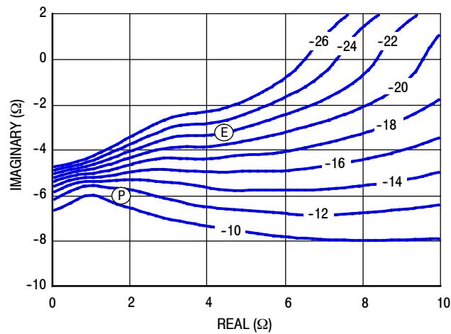
Figure 35. P3dB Load Pull AM/PM Contours (°)
