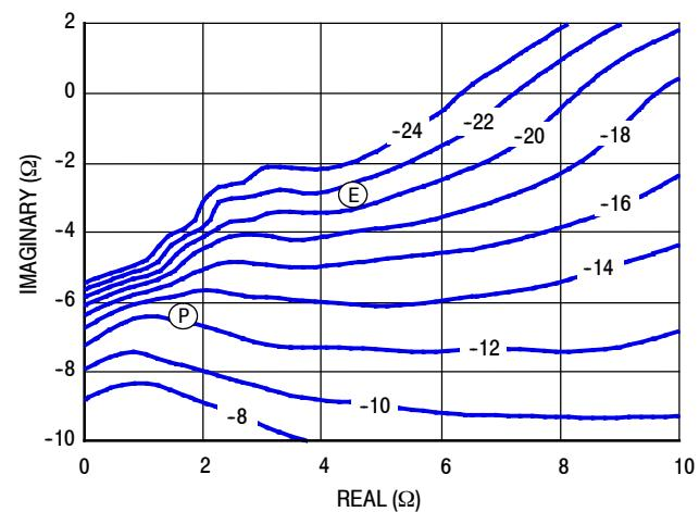
Figure 39. P1dB Load Pull AM/PM Contours (°)
