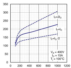
RATE OF CHANGE OF CURRENT : -di/dt(A/μs) di/dt-Qrr CHARACTERISTICS
