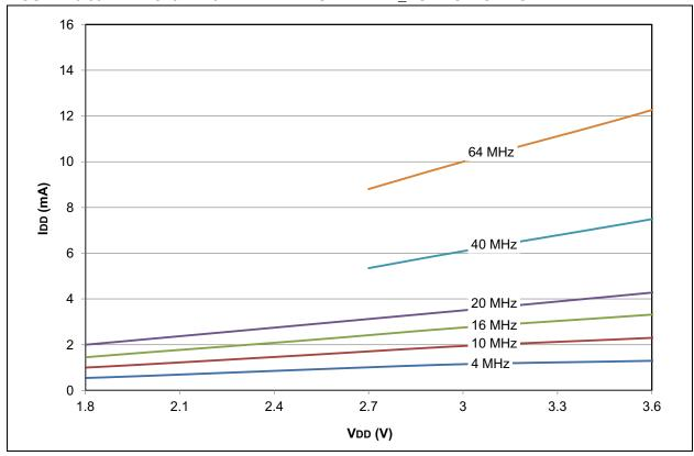
FIGURE 28-54: PIC18F2X/4XK22 TYPICAL IDD: PRI\_RUN EC HIGH POWER
