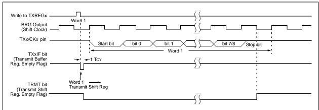
FIGURE 16-4: ASYNCHRONOUS TRANSMISSION (BACK-TO-BACK)
