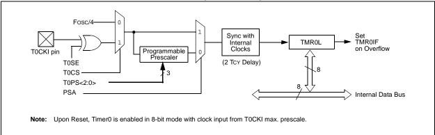
FIGURE 11-2: TIMERO BLOCK DIAGRAM (16-BIT MODE)
