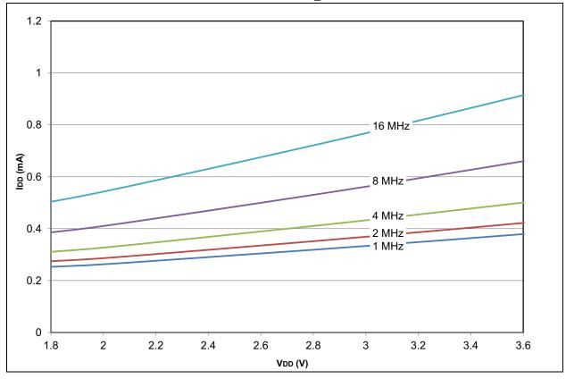
FIGURE 28-41: PIC18LF2X/4XK22 MAXIMUM IDD: RC\_IDLE HF-INTOSC
