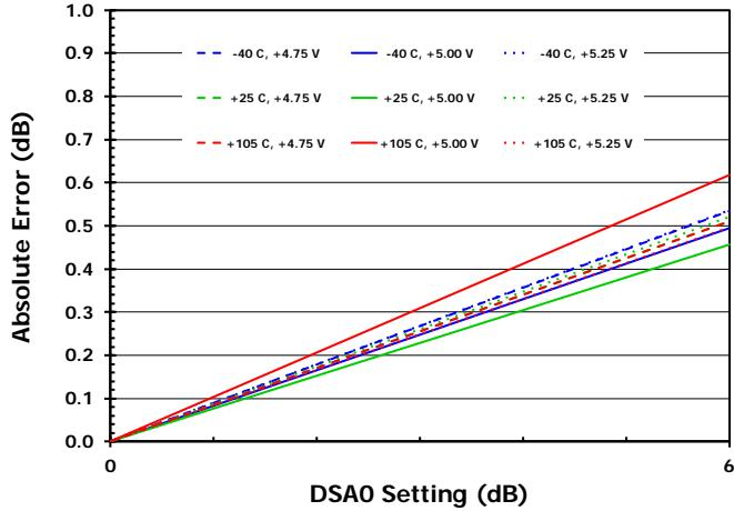
Figure 20. DSA0 Attenuator Step Error (DNL)
